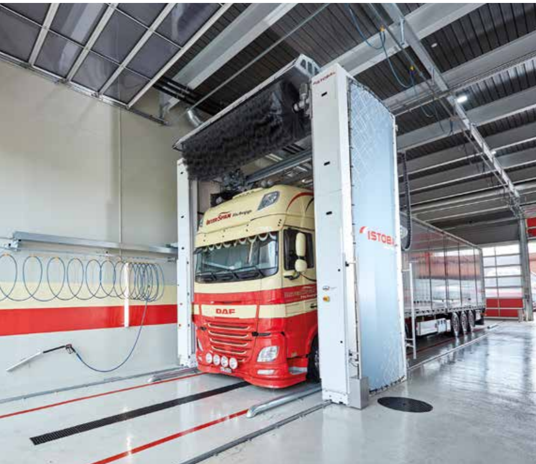
Massgeschneiderte Waschprogramme mit Bürste oder Hochdruckdüsen für Schwergewichte.
