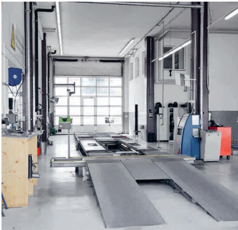
Fourni par KSU A-Technik AG : Trois pistes d'essai avec système euro Maha, testeur de freins, de l'amortisseur et de ripage
