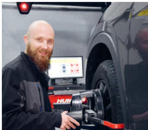
Les calottes sont fixées aux quatre roues avec des attaches rapides à la surface du pneu, faciles et rapides. Avantages décisifs pour l'opérateur et les clients.
