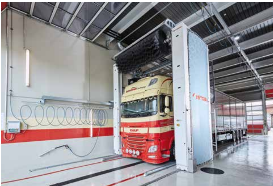
Massgeschneiderte Waschprogramme mit Bürste oder Hochdruckdüsen für Schwergewichte
