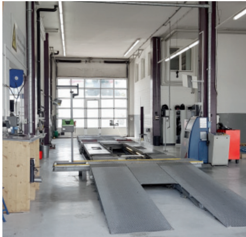
Durch KSU A-Technik AG geliefert: Drei Prüfstrassen mit Maha Eurosystem Brems-, Stossdämpferprüfstand und Spurplatten
