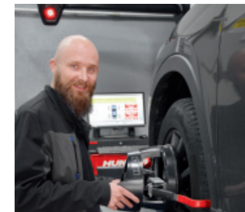
Die Kalotten werden an allen vier Rädern mit beidseitigen Klappverschlüssen auf der Lauffläche des Pneus festgeklemmt, einfach und sehr schnell! Entscheidende Vorteile für einen Mehrwert des Fachbetriebes und des Kunden!
