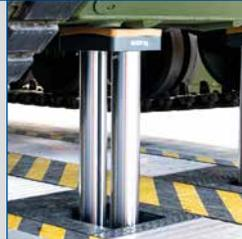
Verdrehsicherung durch biegefestes Doppelzylindersystem mit integrierter Selbstschmierung.
