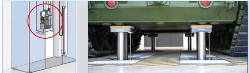
Der eingebaute Unteröl-motor gewährleistet ein sehr leises und souveränes Arbeiten.
