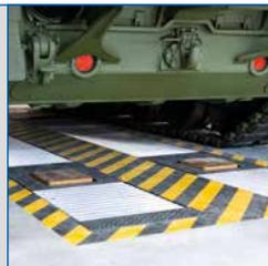
Bei Nichtbenutzung der Hebebühne kann zur Nutzung der Fahrzeughalle die robuste Rollabdeckung mit einer Radlast von 4,5 t (Achslast 9 t) überfahren werden.
