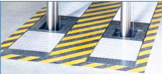
Ein sicheres und einfaches Arbeiten rund um das angehobene Fahrzeug gewährleistet das robuste Rollabdeckungssystem mit elektronischem Fahrentrieb und korrosions- sowie rutschfreier Aluminiumoberfläche.
