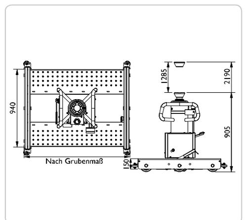
• Die Grube muss mit Schienen ausgerüstet sein (100 x 100 x 10 mm)
