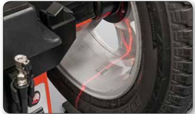
Laser au point mort bas et illumination de roue
