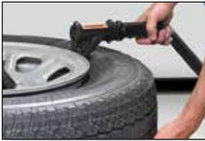
*Air-Schock-Befüllung - Schickt einen großen Luftstoß zur undichten Stelle.*
