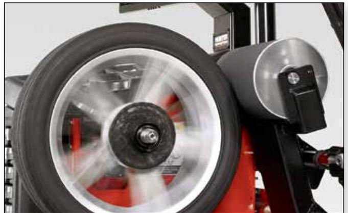
In Kombination mit der Hunter Road Force-Touch®, kann die Maverick™ schnell und einfach Vibrationen beheben, die alleine durch Auswuchten nicht behoben werden können.
