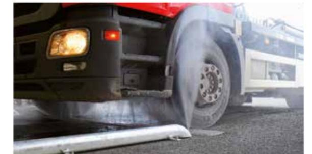
Système haute pression pour le lavage de bas de caisse au défilé à 70 bar et 126 L/min. Équipé de cellules de détection à l'entrée pour l'activation automatique, et de **10 buses à fort impact**. Peut être alimenté par le même rack haute pression que les cyclojets inférieurs s'il y a suffisamment de distance entre le module de cyclojets et celui du lavage de bas de caisse.
