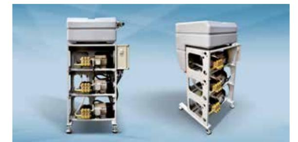
Nous disposons de racks de pompes pour le lavage à haute pression à 70 bar et 126 L/min, avec une puissance de 11 ou 16,5 kW, composés respectivement de 2 ou 3 pompes 70 bar à une puissance de 5,5 kW. Ils incluent un réservoir d'eau de 200 L en position relevée pour l'alimentation des pompes, et une vanne by-pass avec réglage de pression. Son filtre d'entrée de 100 microns protège les pompes et empêche le colmatage des buses.
