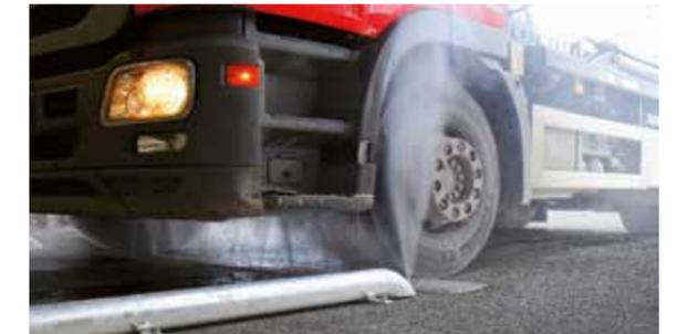
Hochdrucksystem für die Unterbodenwäsche bei Durchfahrt mit 70 bar und 126 L/min. Verfügt über Fotozellen an der Einfahrt zum automatischen Antrieb sowie über **10 Düsen mit hoher Aufprallkraft**. Kann mit demselben HD-Aggregat wie die unteren rotierenden Hochdruckwäschen gespeist werden, sofern auf der Fahrbahn genug Abstand zwischen den Modulen rotierender Hochdruckwäschen und der Unterbodenwäsche vorhanden ist.
