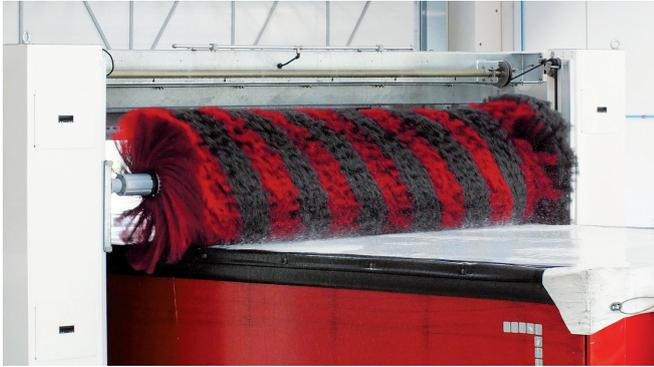
Die Dachbürste aus hochdichtem Polyethylen verfügt über einen Frequenzumrichter, damit die Hebe- und Senkbewegung sanfter ist, sowie über **5 verschiedene Druckniveaus** zur Anpassung an die unterschiedlichen Fahrzeugprofile. Außerdem ermöglicht die in diesem Modell integrierte flexible Konfiguration bis zu 4 Konturverfolgungen, um Hindernisse, wie Rückspiegel oder Sonnenblenden, zu überspringen.
