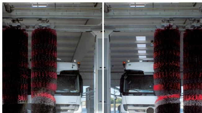
Les brosses verticales automotrices permettent un double balayage des faces avant et arrière des véhicules. La position des brosses en polyéthylène de haute densité est commandée par encodeur et les brosses lavent avec trois niveaux de pression différents pour s'adapter aux différents profils de véhicules. L'inclinaison des brosses breveté à l'avant permet d'améliorer le lavage du pare-brise avant des véhicules à vitre avant inclinée.
