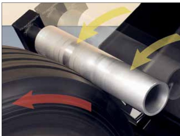
Le rouleau chargé du système GSP9600HD donne la mesure de voile la plus rapide et la plus fiable.
